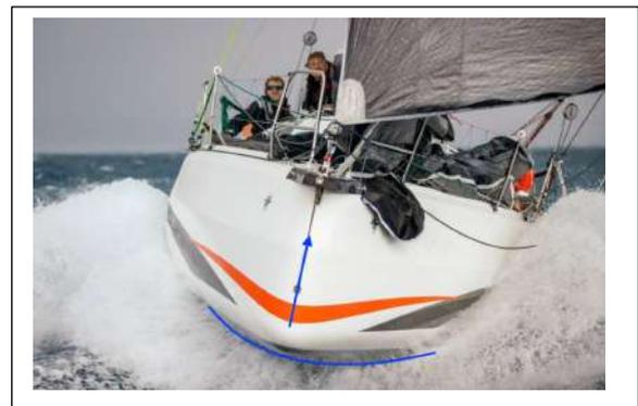
L'analyse des dessins en profil montre que l'architecte cherche à repousser vers l'avant le point de mesure IRC à 45° afin d'être le plus proche possible de l'extrémité avant de LHT.
